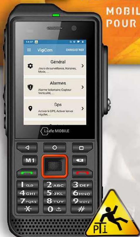
Le mobile **GSM ATI-3620EX ATEX DATI**, est utilisable en conditions extrêmes. Son boîtier robuste lui confère une résistance élevée aux coups et aux chocs. Il est étanche à la poussière et même protégé contre l'immersion dans l'eau (**IP68**) ; il est également certifié pour fonctionner en atmosphères explosives (**ATEX zone 1/21**).
